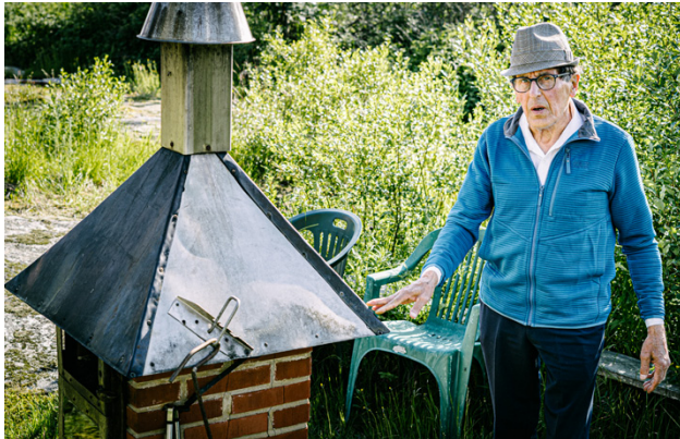
Grillen roterar runt sin egen axel för att man alltid ska kunna grilla i lä.
